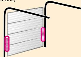
Стандартная направляющая (N-направляющая) – с системой торсионных пружин
