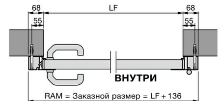
Стальная боковая дверь с алюминиевой блочной коробкой, монтаж в проем. Пример: профиль типа 2.
