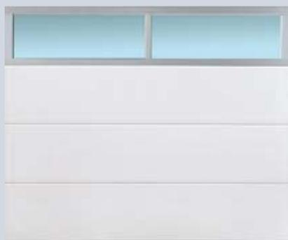
Для всех типов ворот и боковых дверей с гофрами. Рама под остекление из анодированного алюминия (DIN 17611), поверхность протравлена в натуральный цвет E6 / C0 (прежде: E6 / EV1), по желанию – в цвет ворот. Поставляется также в качестве стандартного профиля (NF) или термически разделенного профиля (WF). Одинарное или двойное пластиковое остекление, прозрачное или с кристаллической структурой и с тянутой решеткой.
