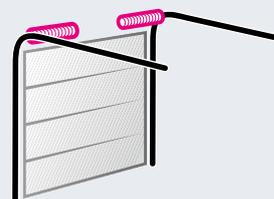
Низководущая направляющая (L-направляющая) с системой торсионных пружин
